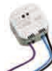
RF265625 Actuador "dimmer" 250W incandescencia y dicroicas con transformador electrónico. No usar con transformadores ferromagnéticos.
